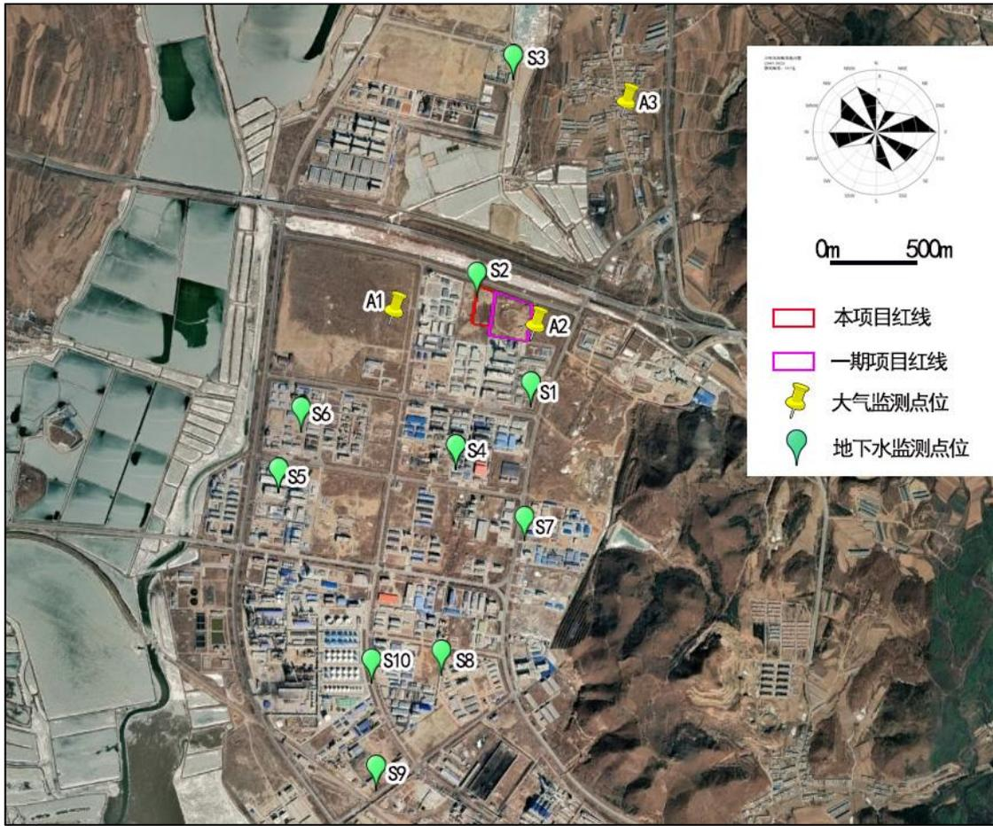
图 5-1 建设项目环境空气、地下水监测点位分布图
